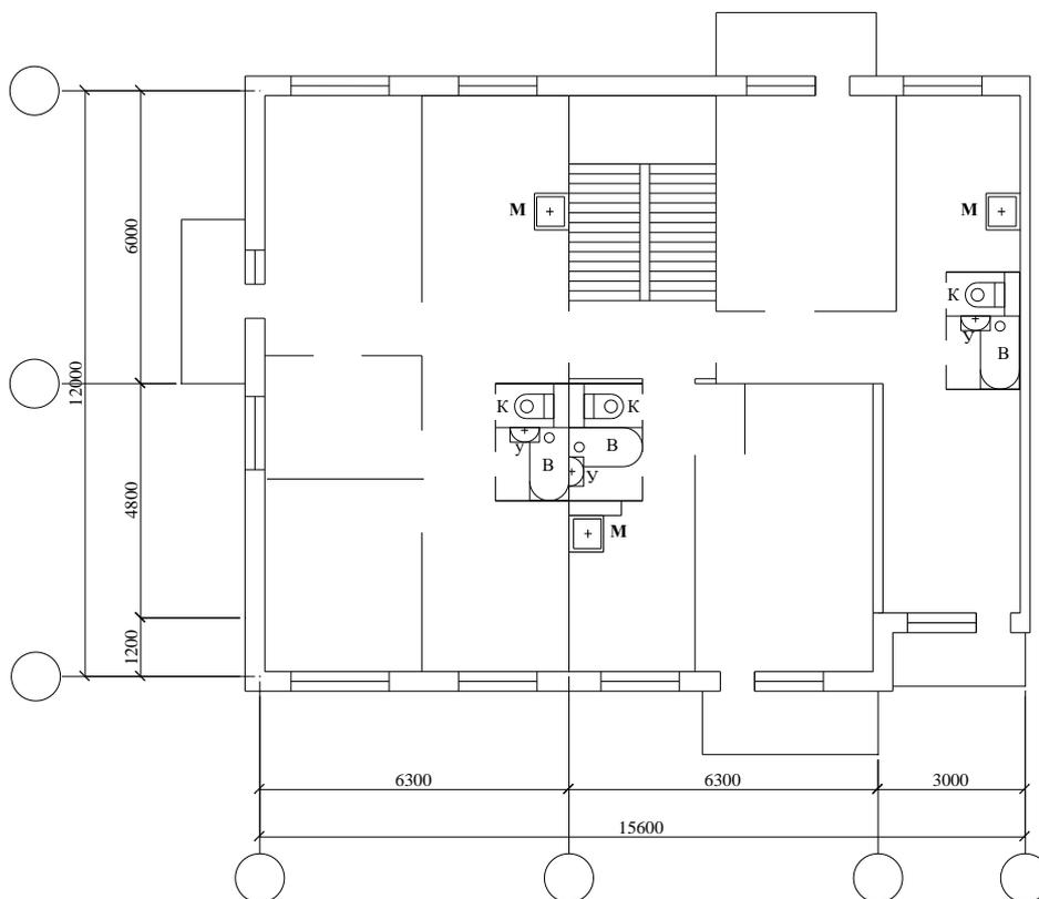
рис. 2 План типового этажа.
