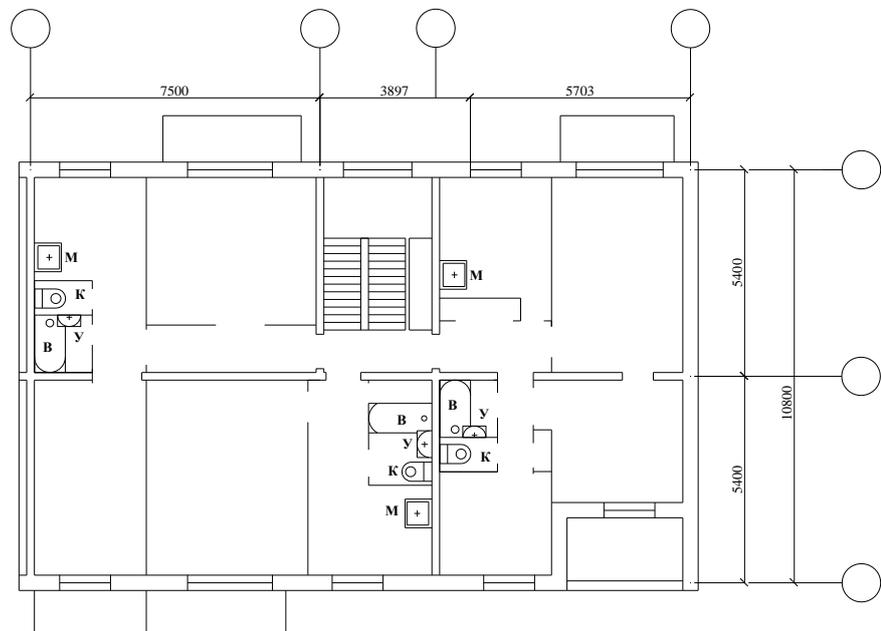
рис. 8 План типового этажа.
