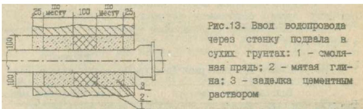
Рис.13. Ввод водопровода через стенку подвала в сухих грунтах: 1 - смоляная прядь; 2 - мятая глина; 3 - заделка цементным раствором
