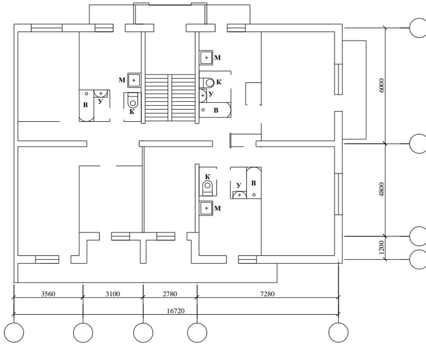
рис. 7 План типового этажа.
