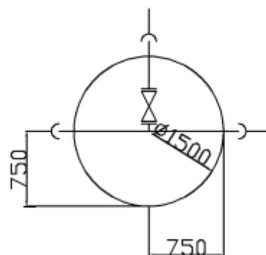
Рис. 1.2. Схема присоединения ввода к наружной водопроводной
