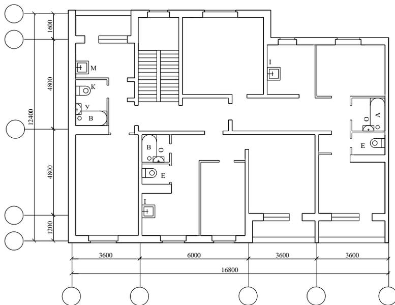
рис. 4 План типового этажа.
